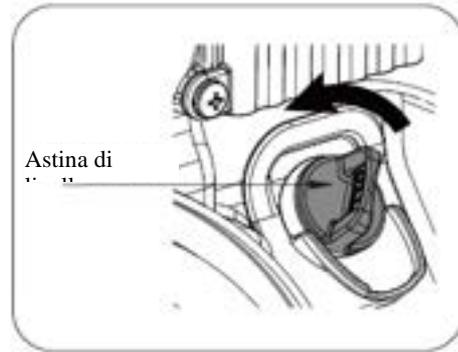
Reinserire l'astina di livello nel foro; appoggiarla sul bocchettone di rifornimento, non avvitare il tappo nel foro.
